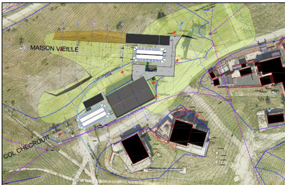
Sistemazione area stazioni partenza con raccordi planialtimetrici
