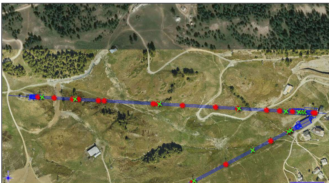
Planimetria con in verde i nuovi sostegni ed in rosso i vecchi
