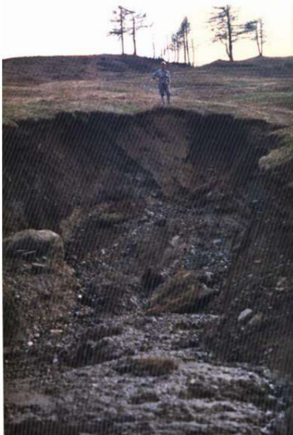
Fenomeno di frana avvenuta a monte di Plan Checrouit nell'ultima decade del maggio 1989. Essa è stata innescata da irrazionale distribuzione delle acque delle scoline della
